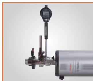
Kalibrace pomocí sady příslušenství pro dutinoměry (typ C)
