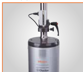
Kontrola lineárního snímače
